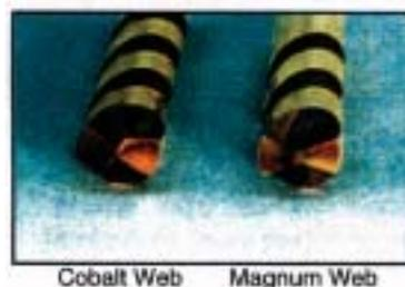
Nous commençons la manufacture des mèches Magnum Super Premium avec un acier spécial haut molybdenum que l'on durcit jusqu'entre 64.5 et 66 sur l'échelle Rockwell C. Ceci est plus précis que les standards d'industrie (qui sont de 63.5 à 66 Rockwell C). Cette échelle plus rapprochée donne une coupe plus consistante avec une dureté moyenne plus élevée donc plus résistante à l'usage.
